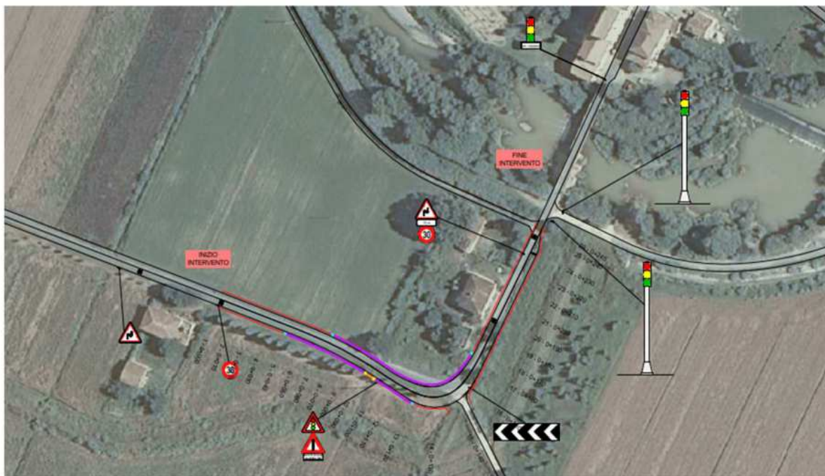
Figura 25- Posizionamento della segnaletica stradale
